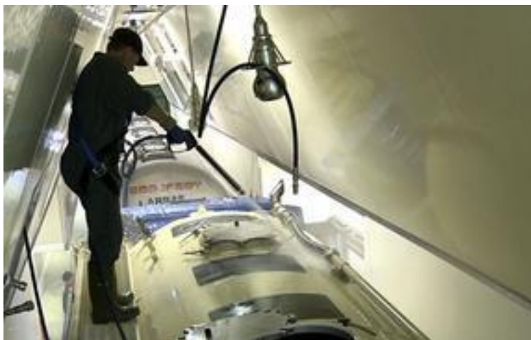
Lavage des citernes
